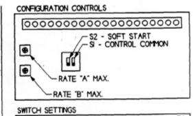
SI - ON CONNECTS THE CONTROL COMMON TO THE LINE NEUTRAL. THIS OPTION IS USUALLY CHOSEN FOR IZO V. CONTROL SI - OFF ISOLATES THE CONTROL COMMON AND INPUTS FROM THE NEUTRAL
